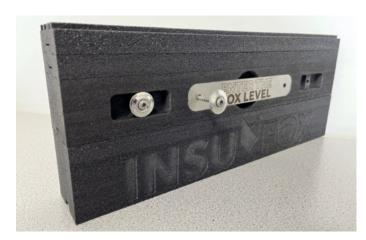
Das Muster vermittelt einen Eindruck von der Materialität des hochverdichteten HT-Schaums, der für das Unterbauprofil Insufox zur Anwendung kommt.
