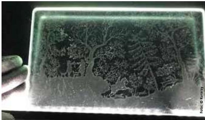
Eine der Patentanmeldungen von Kuraray Europe: Glaszwischenlagen mit unterschiedlichen Brechungsindizes machen Beschriftungen oder Bilder sichtbar, die mit bloßem Auge nicht erkennbar wären.
